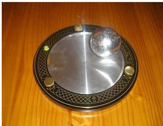
Boulebonnête se postavlja na stabilnu površinu i izravnava pomoću tri vijka. Za početak se testira referentna (dobra) boća.
